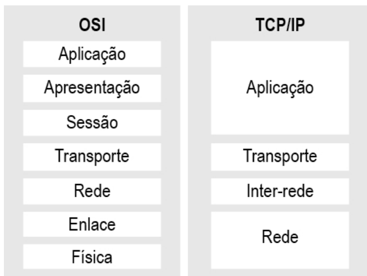
Figura 3.1 – Comparação entre o modelo de referência OSI e o modelo de referência TCP/IP.
